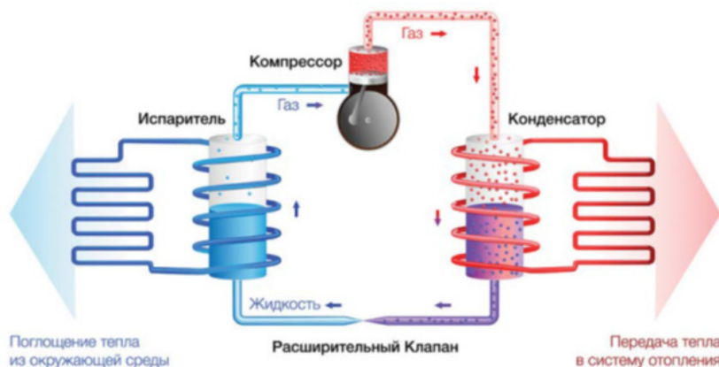
Схема работы теплового насоса
